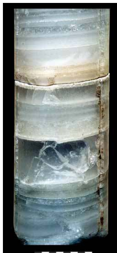
Boorkern van steenzout of haliet. De kern is afkomstig van een diepte van 2716 meter in een boring bij Barradeel (Friesland)
